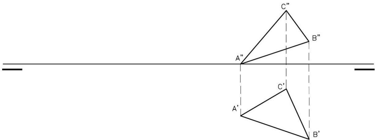
Determinar la PROYECCIÓN VERTICAL DE UN TETRAEDRO con una cara apoyada en el plano horizontal de proyección.
